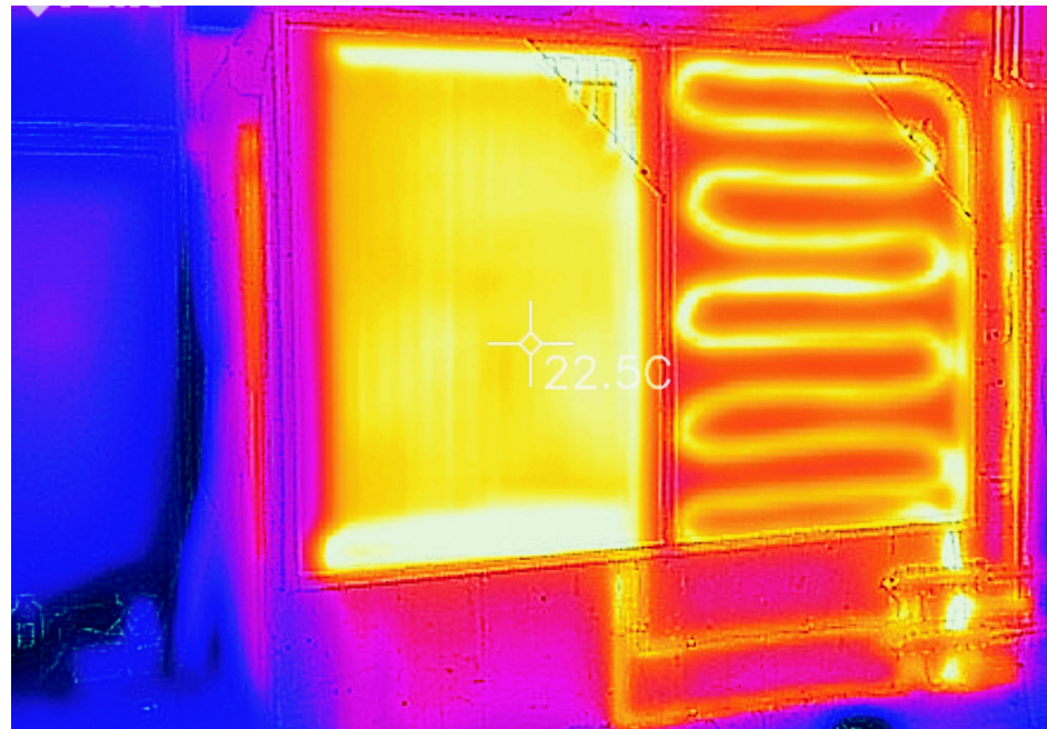
Thermographischer Vergleich von herkömmlicher, serieller (rechts) und effektiver, paralleler (links) Durchströmung
