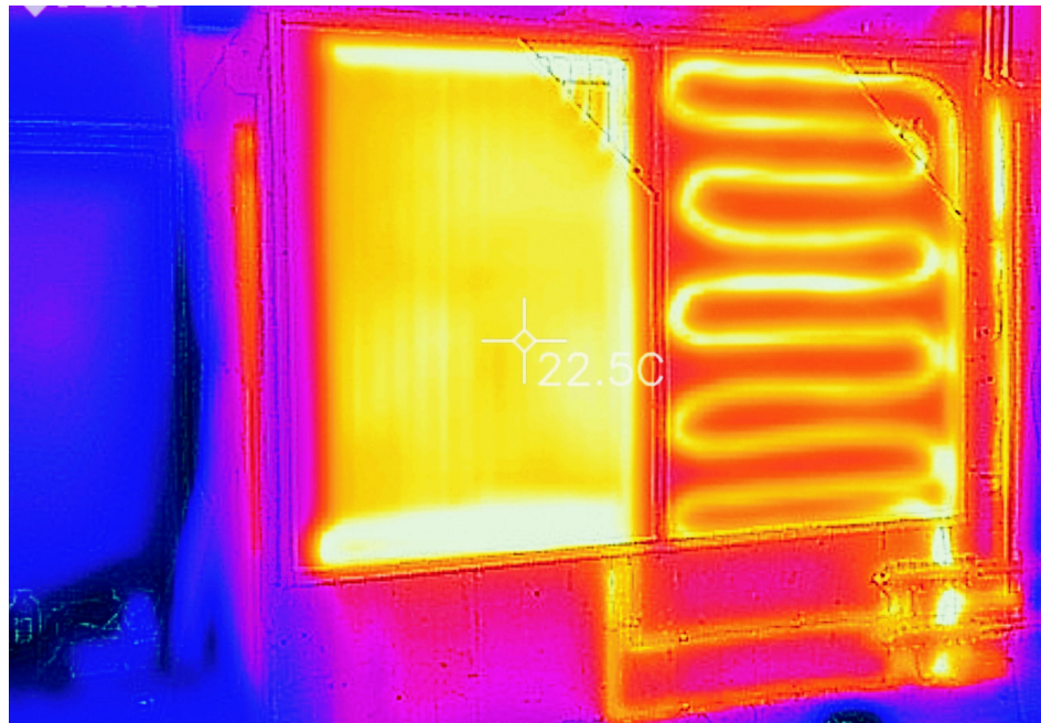
Comparación termográfica de flujo convencional, lineal (derecha) y el más eficiente flujo paralelo (izquierda)
